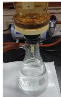
圖 2. 模擬試驗水體中過濾情形
